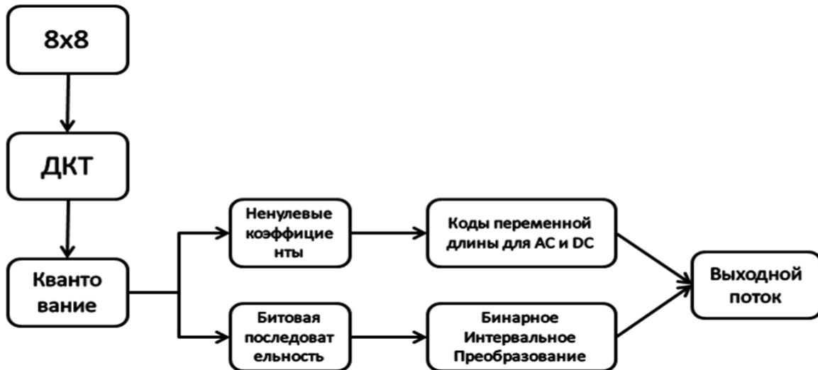
Рис. 7. Схема работы JPEG baseline + BIT
